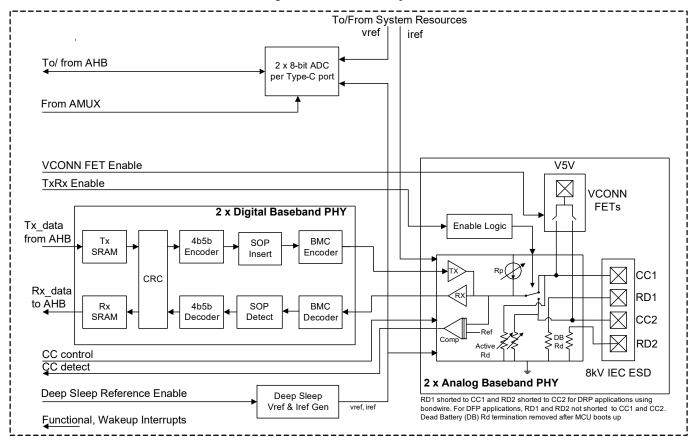
Figure 2. USB-PD Subsystem
